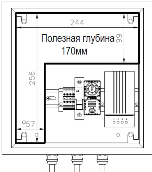
Рис.2. Полезный объем для размещения оборудования
